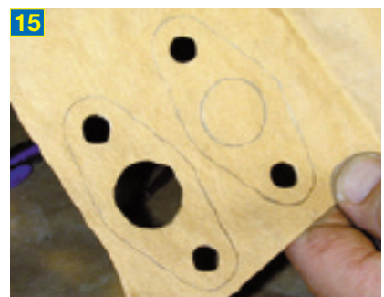
13 Wenn sich kein passender Bolzen findet, nimmt man einen mit einem kleineren Durchmesser und klopft dann innerhalb der Zeichnung ringsum auf das Papier. Dabei sollte der gezeichnete Strich mit ausgestanzt werden, damit das Loch nachher exakt paßt.
