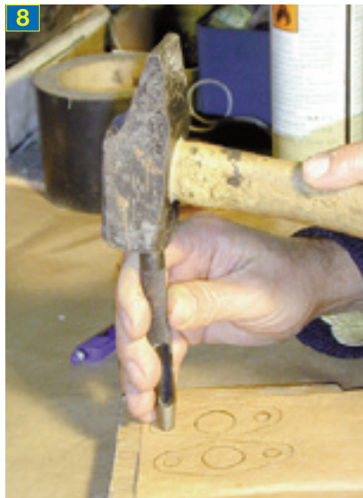
11 Das Papier wird auf ein Holzbrett gelegt; dann positioniert man den Bolzen exakt und schlägt mit dem Hammer drauf.
